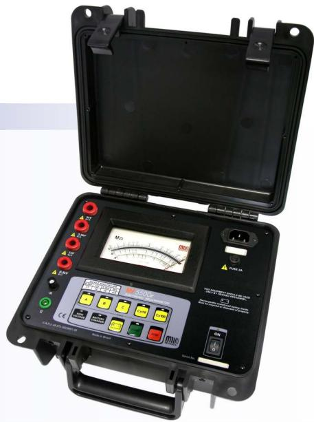
O megôhmetro eletrônico MEGABRAS **MI-5500e** é um equipamento portátil, indicado para medir resistências de isolação de até **10.000.000MΩ** com 4 tensões de prova: **0,5kV - 1kV - 2,5kV - 5kV**. Utiliza uma tecnologia de alta confiabilidade para medições precisas, de fácil leitura de isolações em sistemas elétricos de baixa e média tensão, transformadores, motores, cabos, equipamentos e instalações eletromédicas, redes de distribuição, etc.
